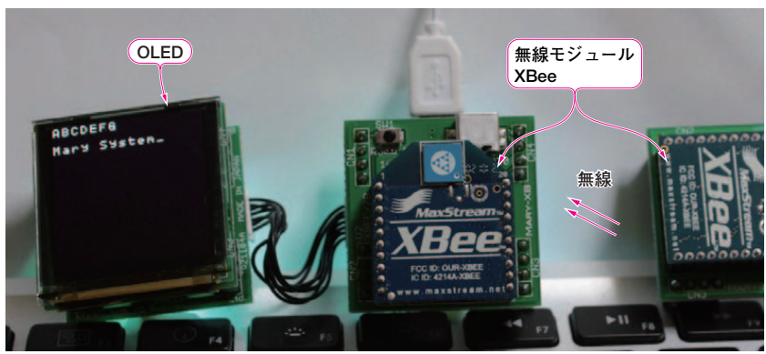
写真6 XBee無線モジュールの接続実験
